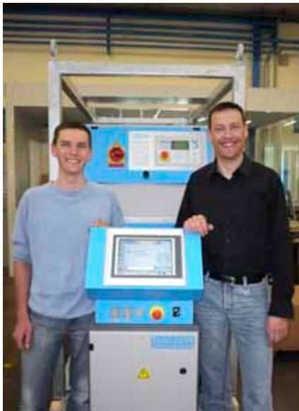
Die Verteilerkästen steuern und überwachen die Stickstoffinjektion in enger Abstimmung mit der Spritzgussmaschine.
